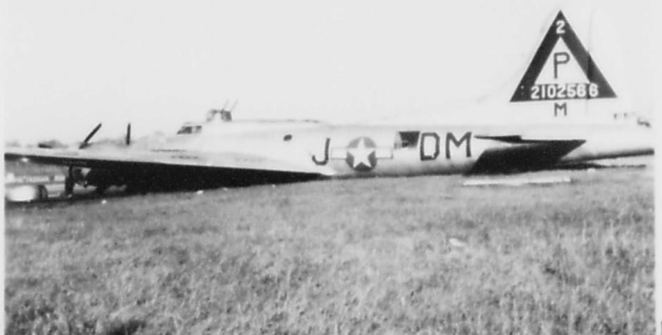
(GAD-88-2-384) (21-Nov-44) (7-2102566) Landing Gear Failure
